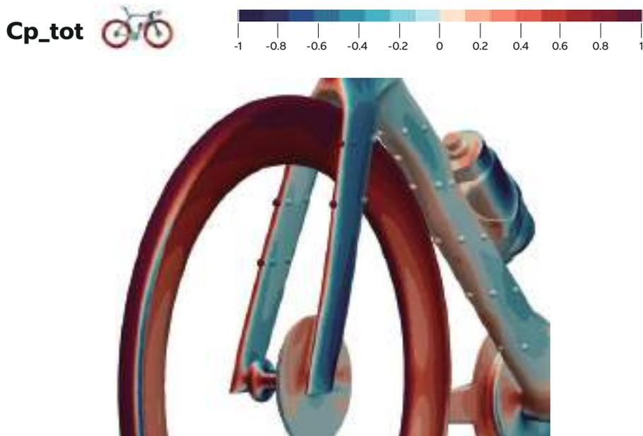
\*경계층(Boundary Layer)은 물체의 표면을 따라 흐르는 유체에 의해 형성된 표면 바로 근처의 얇은 유체 층입니다. 그 두께는 다양한 요인(유체 종류, 속도, 분석된 물체 형상 등)에 따라 달라지며 자전거 분석 시 일반적으로 몇 밀리미터 두께입니다.
